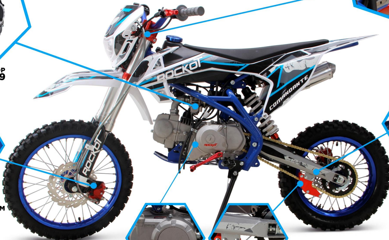
ДВИГАТЕЛЬ YINXIANG 4T 153FM1 ОБЪЕМ 124,6 см 3
