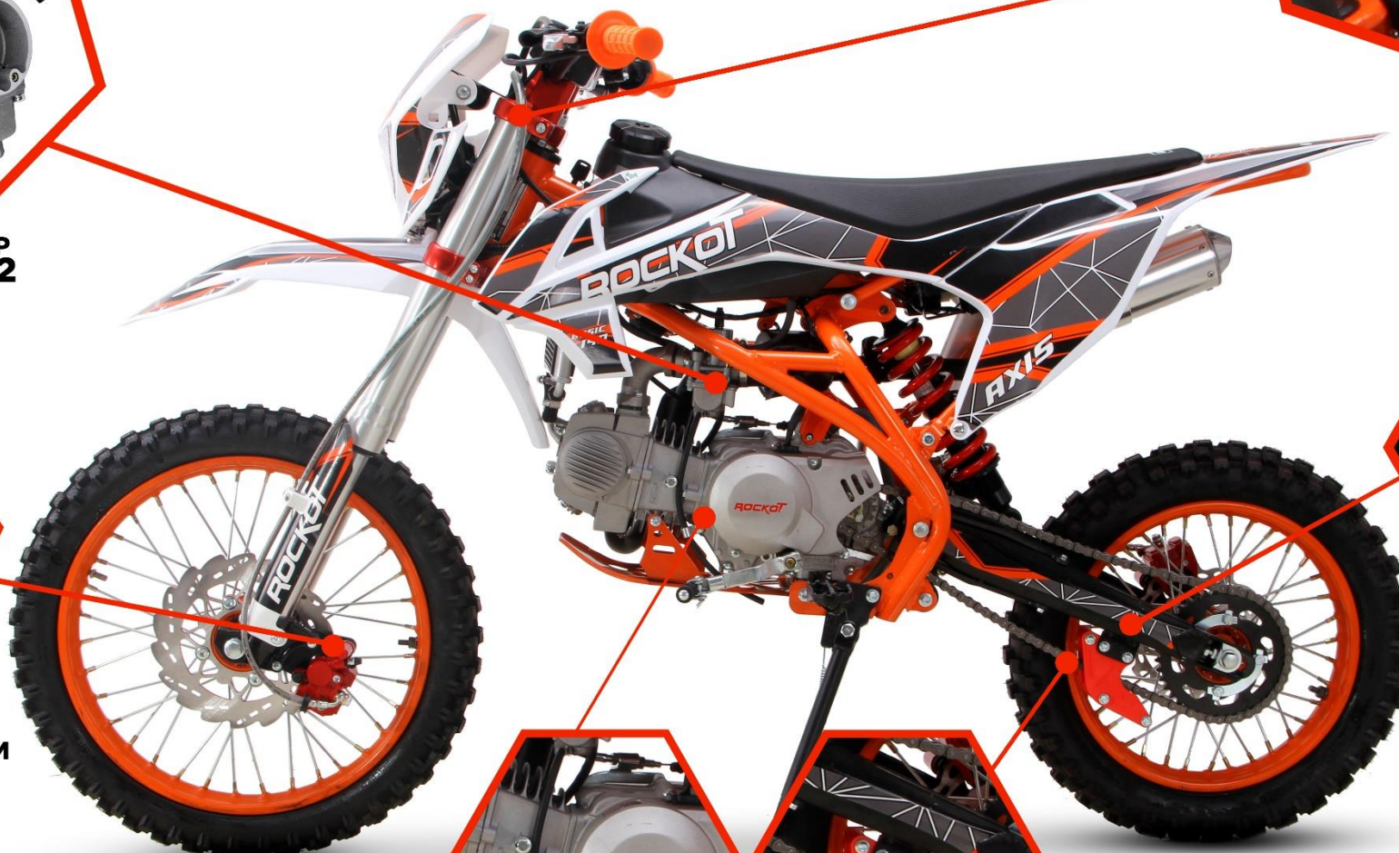
ДВИГАТЕЛЬ YINXIANG 4T 156FMJ ОБЪЕМ 140 см 3
