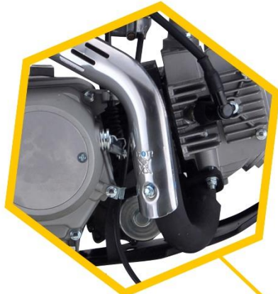
Выхлопная труба с защитной накладкой
